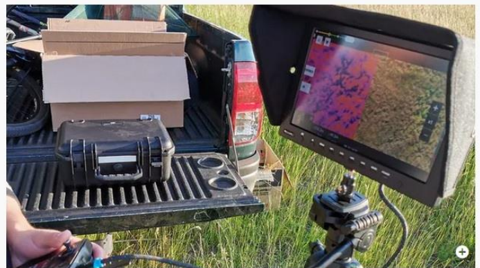
Der zweigeteilte Monitor. Links das Wärmebild, rechts das reale Bild. Bildrechte: MDR/Bernd-Volker Brahm
